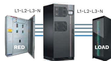
instalación de 4 conductores (L1-L2-L3-N)
