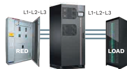
instalación de 3 conductores (L1-L2-L3)
